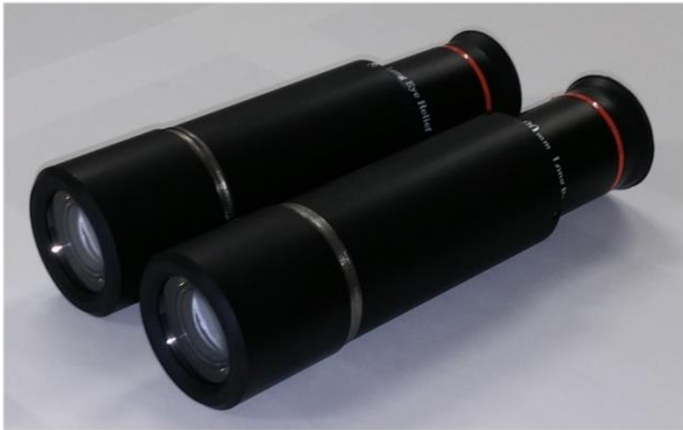
完成した広角中心窩双眼鏡(写真はオールガラスの場合(A2))
